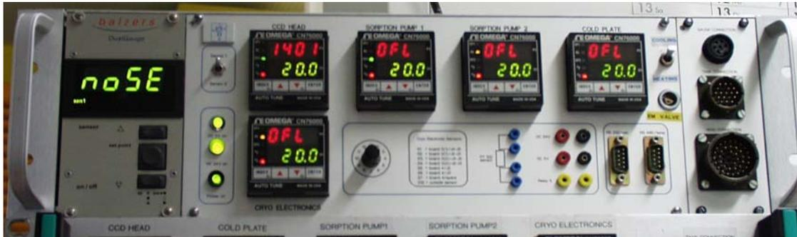
Der Crymac [15] besteht aus 5 PID Reglern des Typs Omega CN 76000, die die Temperaturen im Kryostaten und im CCD head über Temperaturwiderstände messen und über Heizwiderstände regeln. In der Abbildung zeigen alle gerade eine grüne „20“ an.
