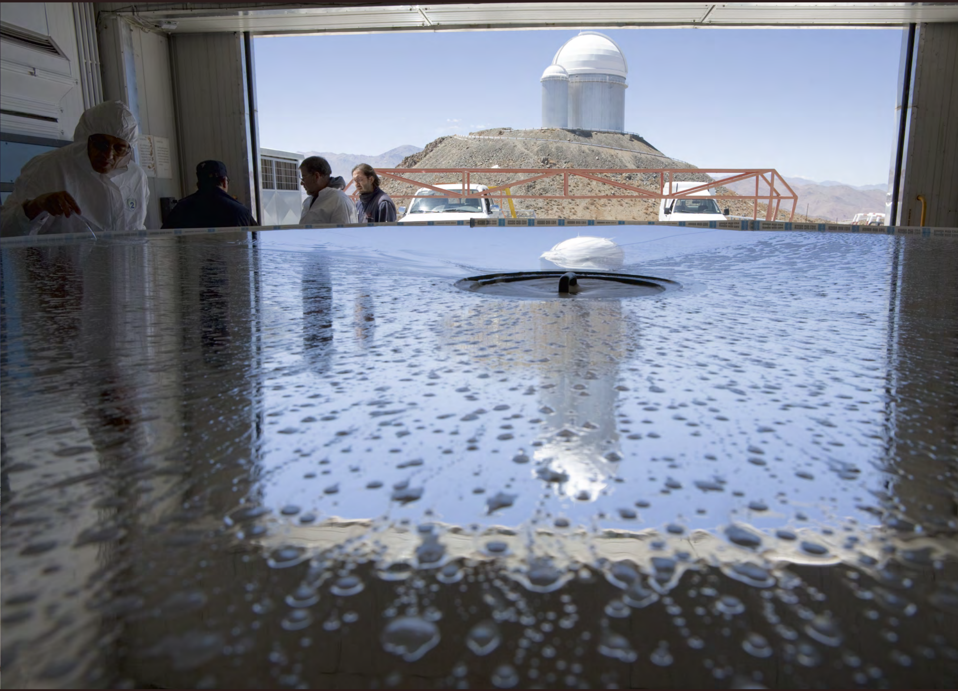
Zwierciadło główne NTT jest wymontowywane z teleskopu dwa razy w roku w celu czyszczenia.
