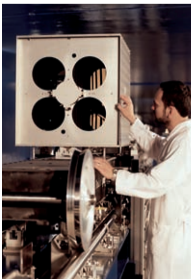
Ein Spiegel-Waggon, der zur Verzögerungslinie im interferometrischen Tunnel gehört, in seiner Parkposition
