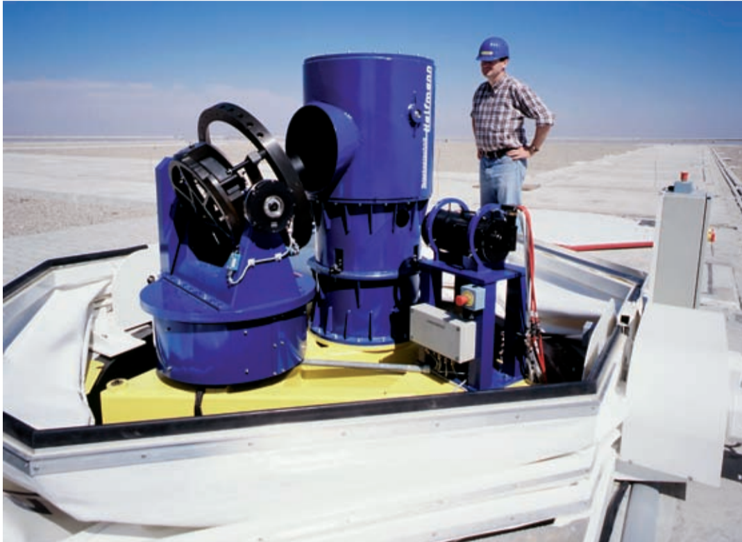
Das Interferometer wurde zunächst mit kleinen 40-Zentimeter-Teleskopen getestet. Künftig werden an solchen Stationen über dem Tunnel die 1,8-Meter-Hilfsteleskope aufgestellt.
