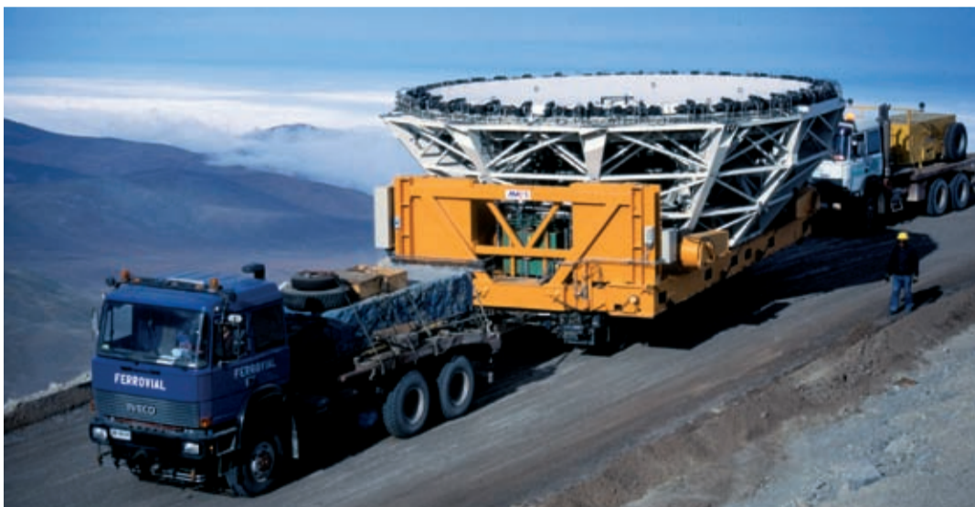
Jeder Spiegel wird mindestens alle zwei Jahre samt Spiegelzelle ausgebaut und hinunter ins Basiccamp gefahren. Frisch aluminisiert geht es dann zurück in das Teleskop.
