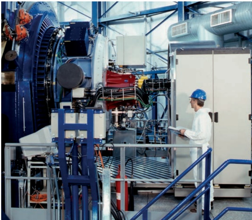
NAOS/CONICA, montiert am VLT-Teleskop Yepun (UT4). Im dunkelblauen Bereich kommt das Licht aus dem Teleskop. NAOS (hellblau) korrigiert das Bild mittels adaptiver Optik – es ist in Zusammenarbeit mit ESO von ONERA (Office National d'Etudes et de Recherches Aérospatiales), dem Labor für Astrophysik in Grenoble und den DESPA- und DASGAL-Laboratorien des Observatoire de Paris in Frankreich entwickelt worden. Die Infrarotkamera CONICA (rot) wurde in Zusammenarbeit mit ESO von den Max-Planck-Instituten für Astronomie in Heidelberg und für Extraterrestrische Physik in Garching gebaut.
